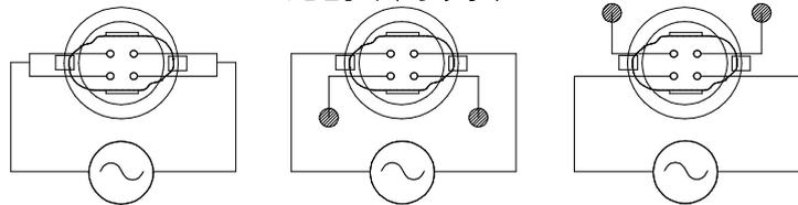
配線施工後、上図印の余剰線端末部分を不用意に短絡しないよう絶縁処理すること。
